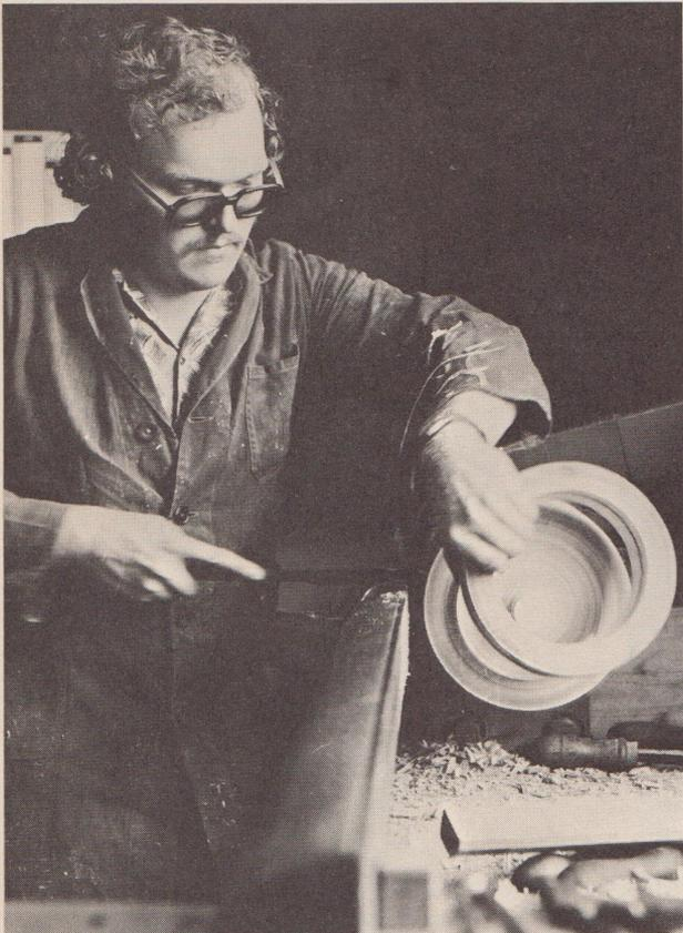
Der halbfertige Reifen wird abgestochen und fällt bei rotierendem Stammabschnitt ab
