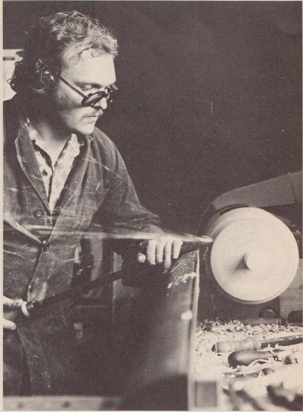
Der Stammabschnitt wird konisch abgedreht, damit der halbfertige Ring aufgepasst werden kann
